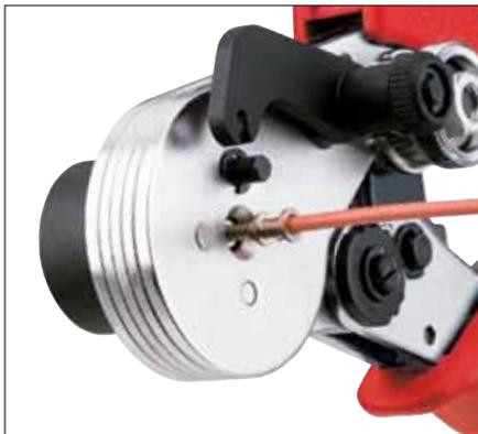
exakte Lagebestimmung des Crimpkontaktes in der Zange mittels Arretierhebel
