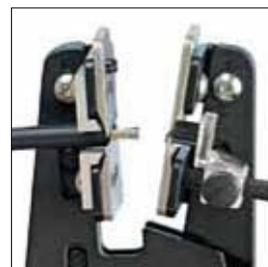
Automatisches Abziehen der Isolation
