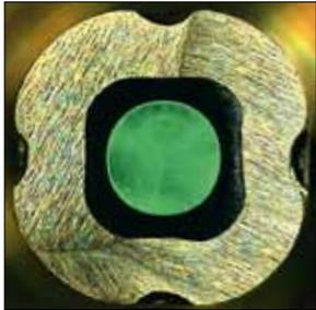
sicherer Crimp des Verbinders auf der Isolation ohne Deformation der LWL-Faser
