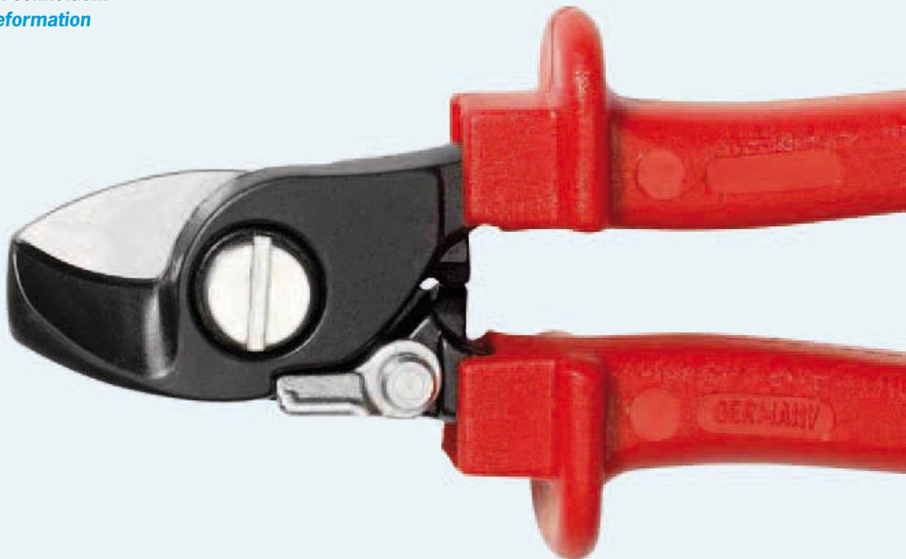
optimierte Schneidengeometrie mit Präzisionsschliff, gehärteter Schneidkopf aus geschmiedetem Spezialstahl, nachstellbares Schraubgelenk, ergonomischer Griff
